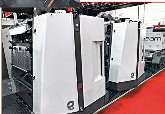
3. Omet Varyflex-V2 variabele offsetrotatie met EB-droging.
