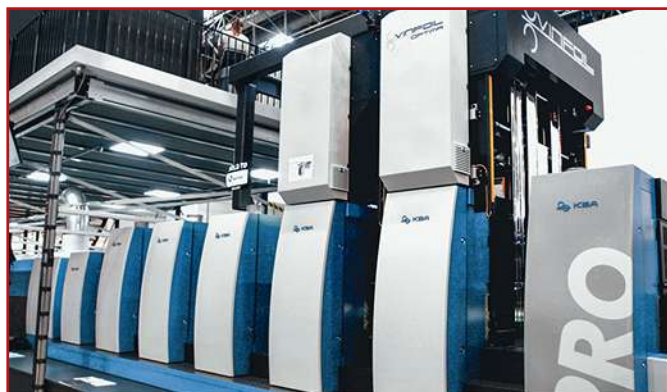
14. KBA Rapida 105PRO met Vinfoil's nieuwe koudfoliesysteem.
