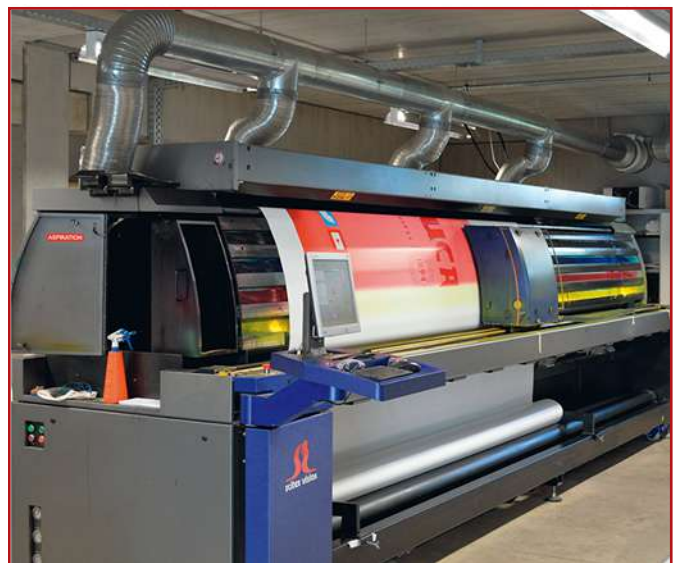
Bij Schmitz Digital Printing zijn de printsystemen van een afzuigstelsel voorzien.
