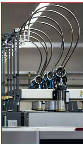
De centrale inktaanvoer bij de 8-kleuren offsetpersen van Onlineprinters, een milieuvriendelijke en doeltreffende oplossing. °
