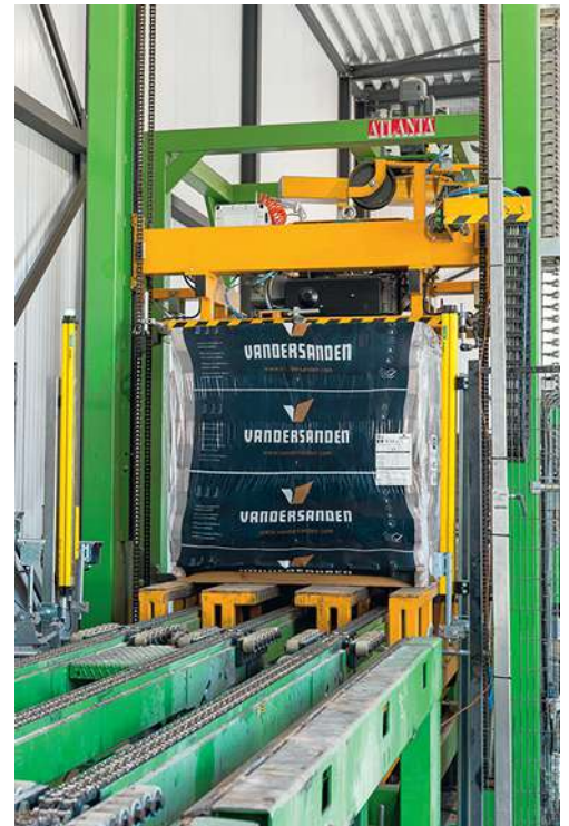
Het bandkanaal met de vele kleine stabiele klappetten zorgt ervoor dat de omsnoeringskop overal kan stoppen.
