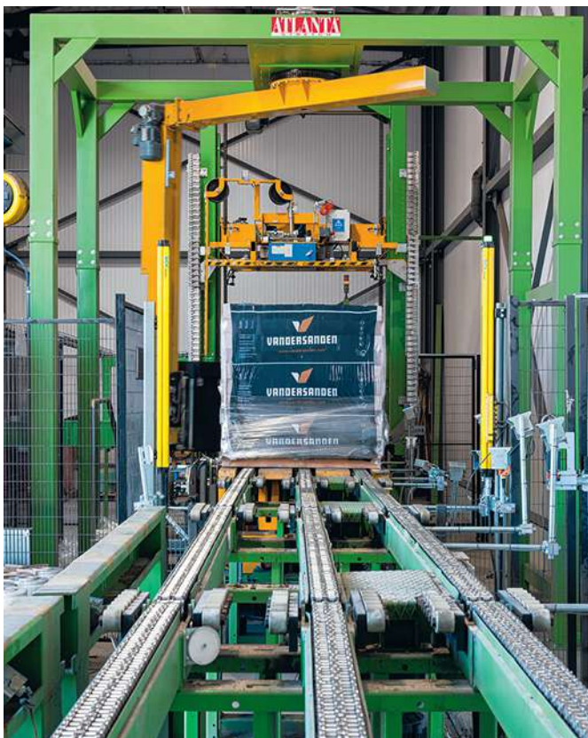
Het motorisch gestuurd voorreksysteem van de armwikkelaar en de palletlift zorgen voor een zeer stabiele verpakking.
