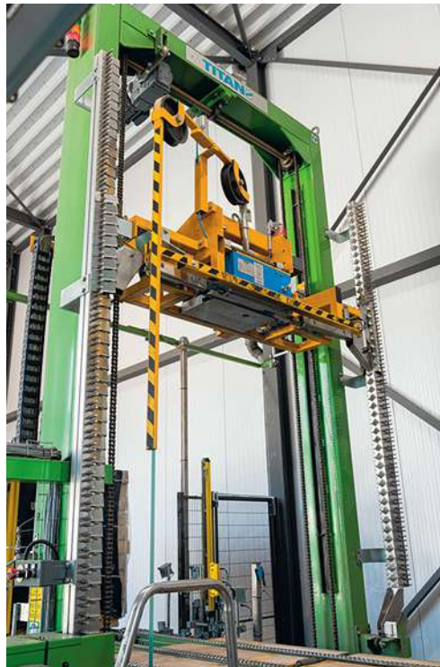
Doordat de Titan omsnoerkop bovenaan staat, kan deze de hoogteverschillen van de palletten moeiteloos aan.
