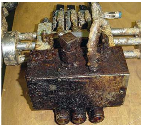
Een met lijm vervuild lijmaparaat.
