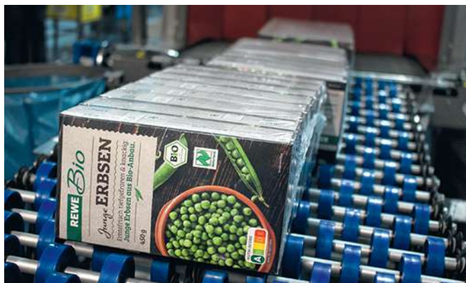
Na het bundelen worden de doosjes verder richting eindverpakken getransporteerd.
