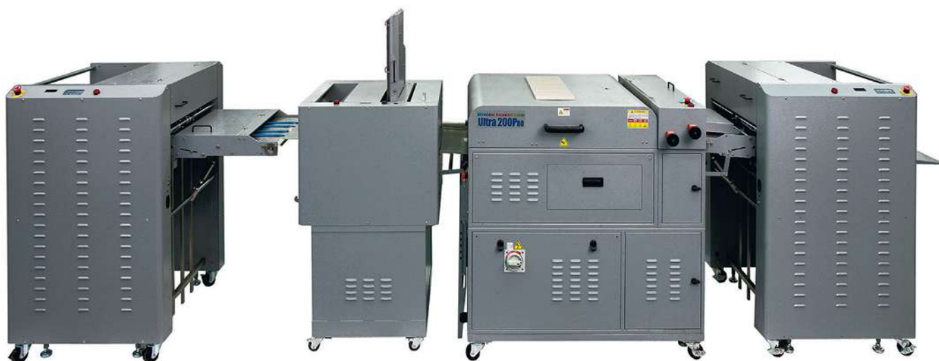
De configuratie 'Duplex Ready' met de module 'Flipper' (2 e eenheid links) kan de vellen automatisch omkeren om ze recto en verso te vernissen.
