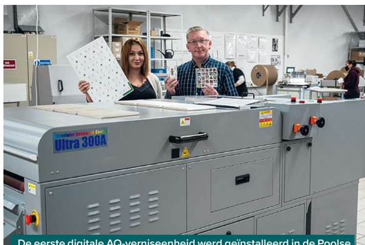
De eerste digitale AQ-verniseenheid werd geïnstalleerd in de Poolse vestiging van Cewe voor de productie van kinderboeken en speelkaarten. De verniseenheid maakt gebruik van de vernis op waterbasis van Actega, met de certificatie 'Toy Safe'.
