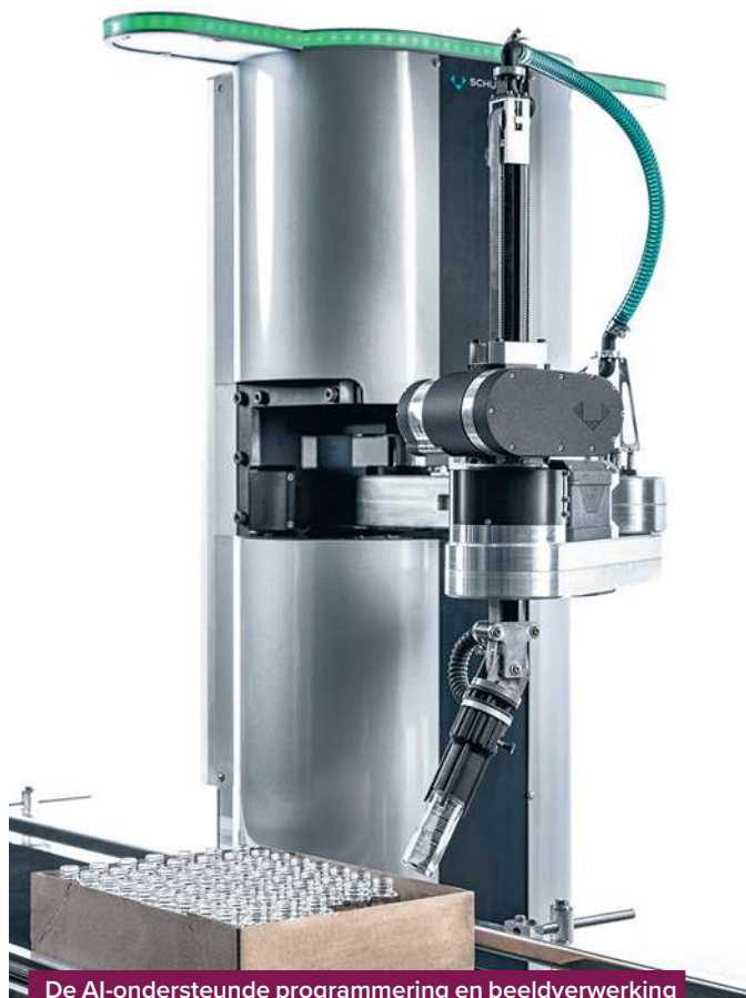
De AI-ondersteunde programmering en beeldverwerking van de cobot tog. 519 helpt operators snel een formaatwissel uit te voeren.
