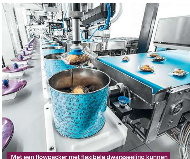
Met een flowpacker met flexibele dwarssealing kunnen verschillende recycleerbare folies op dezelfde lijn worden gebruikt.
