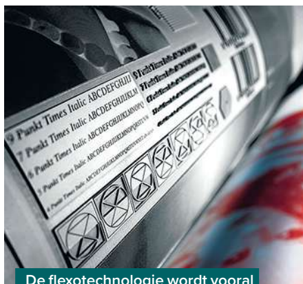
De flexotechnologie wordt vooral gebruikt voor het bedrukken van verpakkingen.
