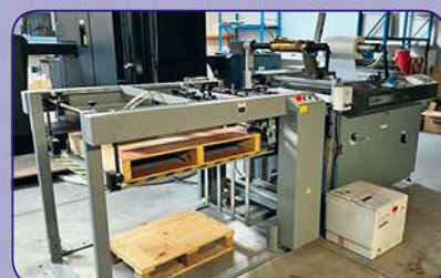
Automatische, compacte lamineermachine DRY KOMFI DELTA van 2013; formaat: 540 x 760 mm, met module vergulden, terugspoelmodule B2 OTFB2 van 2017. Automatische stapelaar B2 met aparte aandrijving SZ-01-B2 van 2015. Teller: 741,34 uren.
