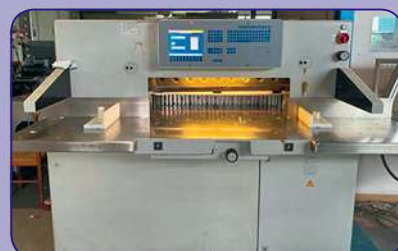
Snijmachine WOHLBERG 92 van 2006, 92 cm, Monobloc, automatisch met PC-technologie, digitaal beeld, kleurenscherm, luchttafel.
