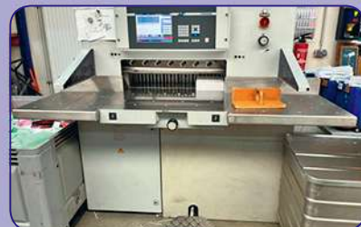
Snelle snijmachine WOHLBERG cut-tec 76 van 2007 n°3107-0009, 76 cm, gestuurd door microprocessor, automatisch, hydraulisch, met digitaal centraal bedieningspaneel.
