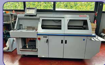
Klembinder HORIZON BQ-280 PUR van 2013; formaat 385x320 mm, 500 boeken per uur.
