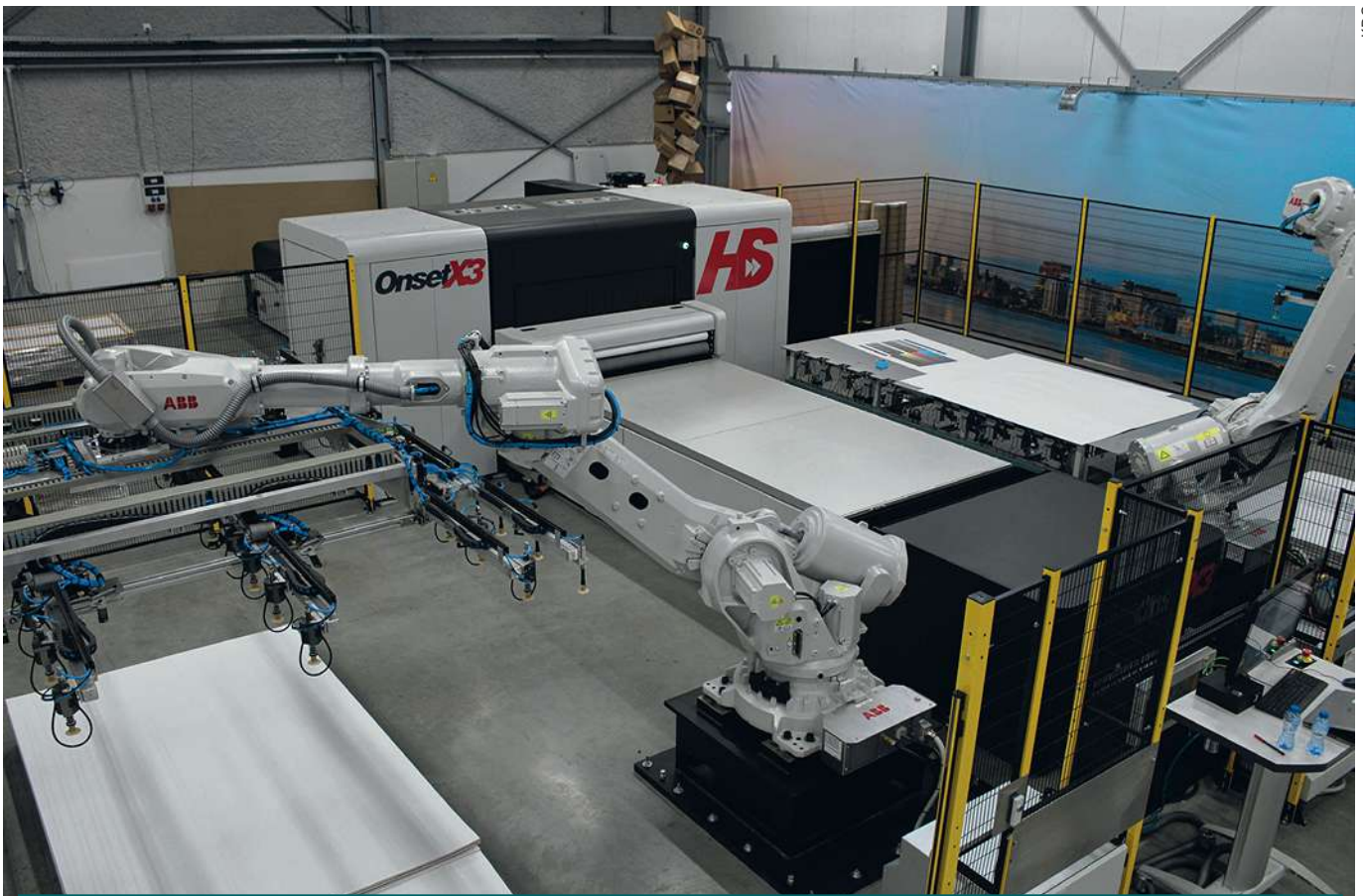
Binnen een geautomatiseerde productie hebben ook robots een plaats in de grootformaatdrukkerijen om de operators zware lasten uit handen te nemen. Op de foto: de Onset X3 HS van Agfa met twee robots die de platen aan- en afvoeren.
