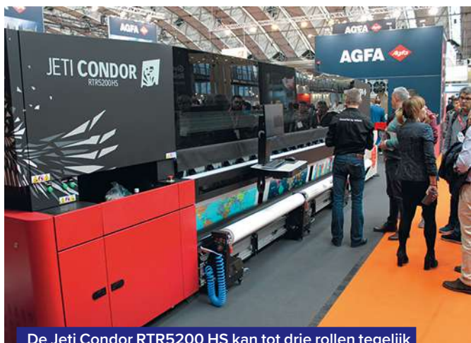
De Jeti Condor RTR5200 HS kan tot drie rollen tegelijk verwerken.
